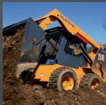
**UNE LARGEUR DE ROULEMENT ÉTENDUE ▲** et un centre de gravité surbaissé sur les modèles 2076 et 2086, pour une plus grande stabilité et des performances optimales sur les surfaces irrégulières.
