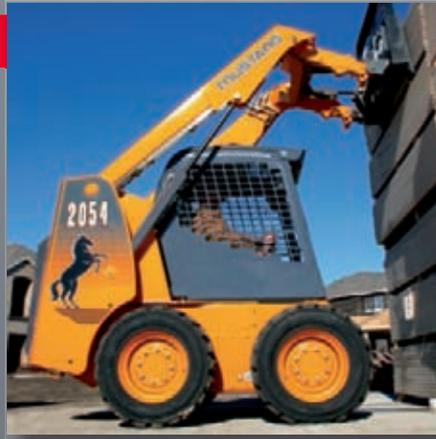
**UNE PLUS GRANDE HAUTEUR DE LEVAGE ▲** pouvant atteindre 2 946 mm, facilitant ainsi la manipulation des matériaux dans les espaces réduits et confinés.
