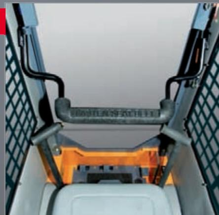
**UN GARDE-CORPS LATÉRAL UNIQUE** ▲ qui se fixe sur le système de sécurité Hydraloc™, renforce la protection, et est entièrement réglable, pour un poste de pilotage ergonomique et sécurisé.
