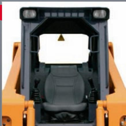
**DES CABINES SPACIEUSES ▲** de série avec siège à suspension réglable (en option sur le 2056 Series II), plafonnier, éclairages de travail, contrôle manuel/à pédales, et commandes manuelles doubles ou un joystick.
