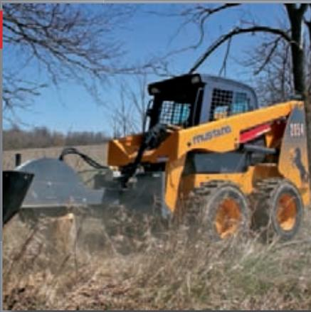
**UN SYSTÈME HYDRAULIQUE AUXILIAIRE ▲** capable d'alimenter un grand nombre d'accessoires. Un débit élevé proposé en option (*modèle 2054*), qui permet de fournir une puissance supplémentaire en cas de besoin.
