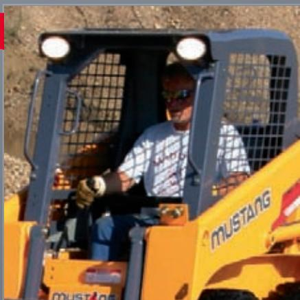
PRENEZ LE CONTRÔLE ▲ avec un T-Bar, mains uniquement ou variante en commande Hand/Foot.
