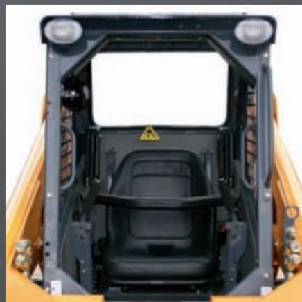
**UNE PROTECTION RENFORCÉE ▲** grâce à la structure robuste ROPS/ FOPS certifiée de niveau II. Les opérateurs bénéficient également d'une vue panoramique dégagée sur l'accessoire et les zones de travail environnantes.
