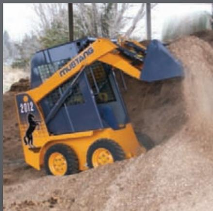
**UN BRAS DE LEVAGE** ▲ muni d'un profil surbaissé et d'une grande résistance, afin d'optimiser la visibilité de l'opérateur et ainsi d'améliorer les performances.
