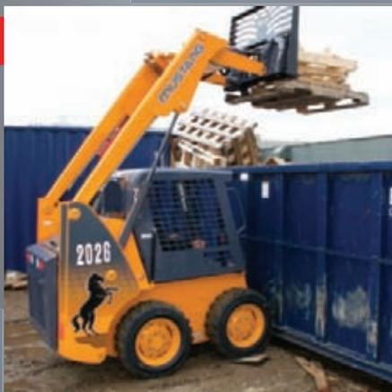
UNE PLUS GRANDE HAUTEUR DE LEVAGE ▲ pouvant atteindre 2 794 mm, facilitant ainsi la manipulation des matériaux dans les espaces réduits et confinés.
