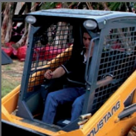
**TROIS OPTIONS DE COMMANDE ▲** disponibles afin de répondre aux besoins de n'importe quel opérateur. Configurations de commande possibles : levier double avec pédales, levier double avec commandes manuelles, et T-Bar avec pédales.
