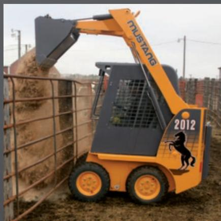
**UNE PLUS GRANDE CAPACITÉ DE TRANSPORT** ▲ avec sa hauteur de levage de 2 438 mm, qui permet de charger et de manipuler les matériaux dans les espaces réduits en toute simplicité.
