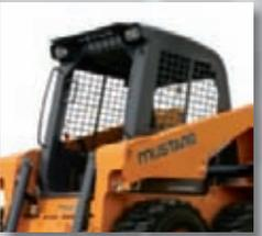
**CABINE PRESSURISÉE ▲** La cabine fermée et pressurisée en option est munie d'un système de chauffage, ou chauffage et climatisation, et offre un environnement de travail plus propre et moins bruyant.
