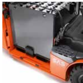
Extraction latérale de la batterie avec des fourreaux de fourches
