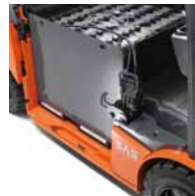
Extraction latérale de la batterie avec convoyeur sur rouleaux
