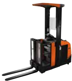
OME100N avec mât auxiliaire et OME100NW à ouverture frontale • Largeur de châssis de 810 mm • Capacité maximale 1 000 kg • Hauteur de picking jusqu'à 3,4 m
